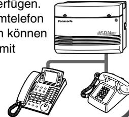
1.4.1 Paralleler Anschluss eines zweiten Telefons
