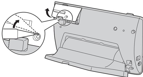
4. Installieren Sie das KX-NT307 Bluetooth Module im Bluetooth Module-Steckplatz (siehe "Anordnung der Bedienelemente (Seite 20)").
